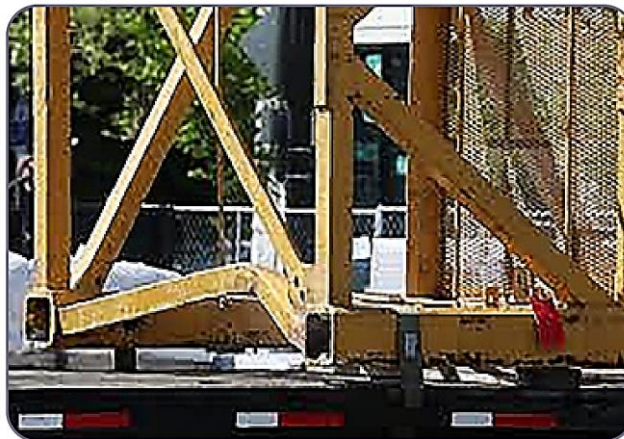
شکل ۵ نمونه‌ای از تغییر شکل بر روی جرثقیل
