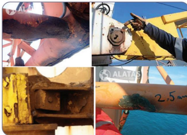
شکل ۷ نمونه‌هایی از خوردگی بر روی جرثقیل‌ها
